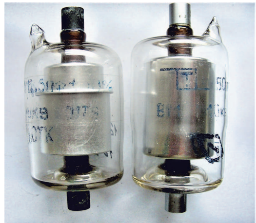
Рис. 2. Вакуумные конденсаторы. В качестве электродов – цилиндры
