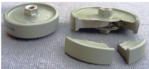
Рис. 7. Высоковольтный конденсатор после пробоя
