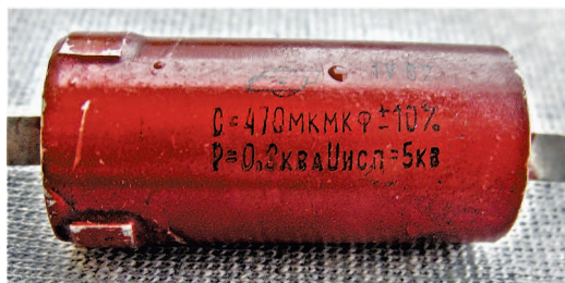
Рис. 9. Конденсатор, на котором указана максимальная рассеиваемая мощность
